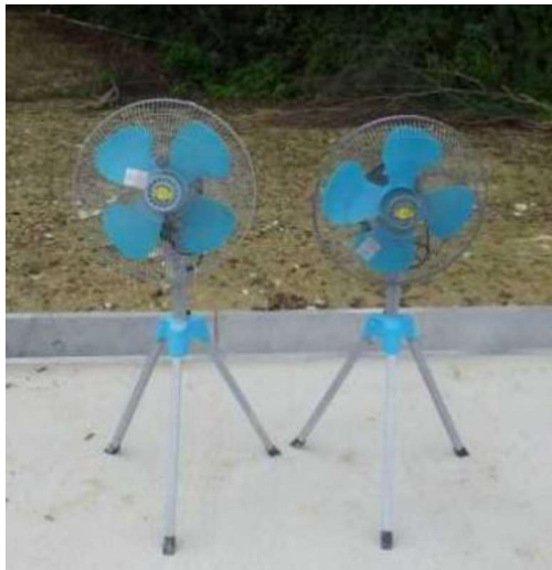
①作業用大型扇風機の設置
