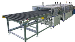
太陽光パネル リサイクル設備
